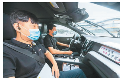
副驾驶座上的测试员手持设备记录监测自动驾驶车辆数据。
