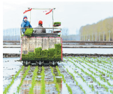
在黑龙江省农垦红兴隆管理局友谊农场的一块水田里,采用北斗导航定位系统的智能导航水稻插秧机正在插秧。
