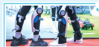
外骨骼护膝机器人主要面向登山徒步及日常助行场景,其核心特点是基于AI自适应算法的运动识别系统,能够通过传感器实时采集步态、关节角度与地形信息,构建用户的行走意图模型,并在起步、加速及上下坡等状态下动态调整助力模式,实现贴合个人节奏的人机协同。在结构设计上,膝关节受力点采用仿生减震机制,用于分散冲击和降低关节压力,从而兼顾户外运动与康养辅助的需求。
