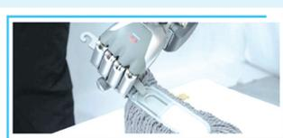
不同类型的Casia Hand灵巧手各有侧重。类人自由度灵巧手由21个驱动控制25个自由度,十分灵活,可完成穿针引线、调制咖啡等精细操作。高速自适应灵巧手的亮点在于最大720度/秒的超手指关节速度,确保了作业效率,让它在快节奏的生产线上游刃有余。三指灵巧手则采用4个主动自由度配合被动自适应结构,能够负载5公斤,手指关节速度超过180度/秒。
