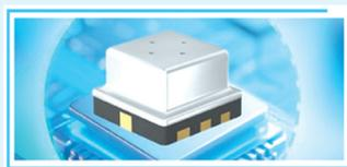
电子鼻的基础是气体敏感单元,将环境中的各种气体浓度通过半导体、电化学、光学等原理转换为电学信号;再使用微机电系统技术将敏感单元微型化,将对不同气体有着不同响应特性的敏感单元阵列化;最后结合AI算法,根据敏感单元阵列的信号对环境气体做定性或定量的检测。电子鼻可以识别生活中常见的饮料、酒、醋等液体。未来,随着材料、集成技术等发展,电子鼻将更为灵敏、智能,应用范围也会更广泛。
