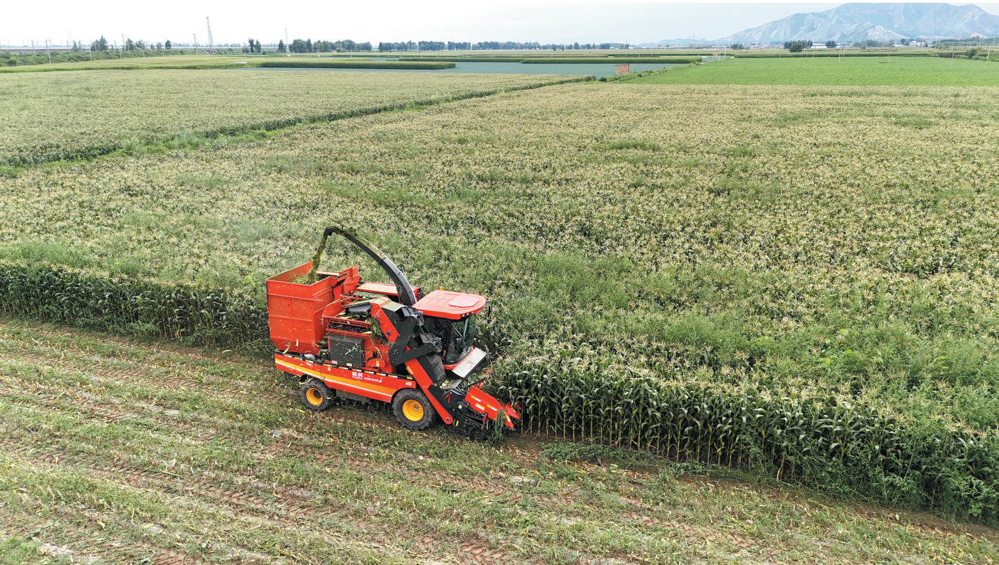
连日来,定襄县宏道镇连片甜糯玉米进入集中收割期。广袤的玉米田里,中型青贮收割机穿梭作业,农机一体化完成果穗采摘与秸秆收储工作。
