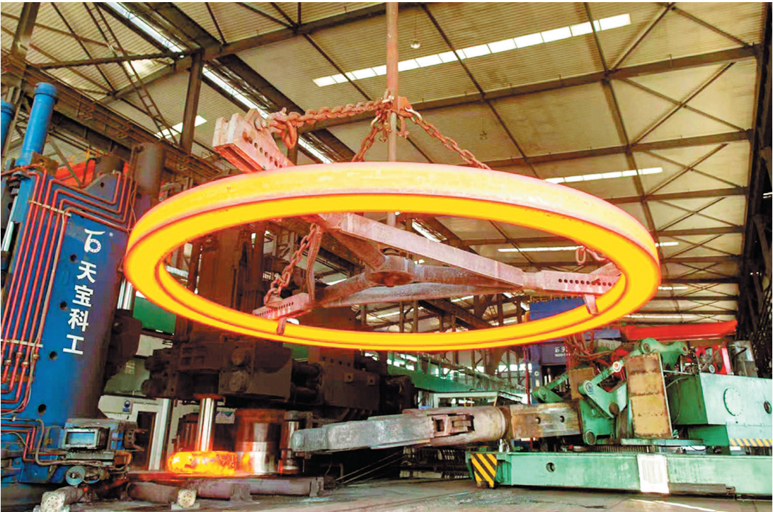
智能车间内,锻件在机械臂的精准夹持下流转。
