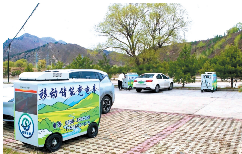
移动储能充电车充电现场。
