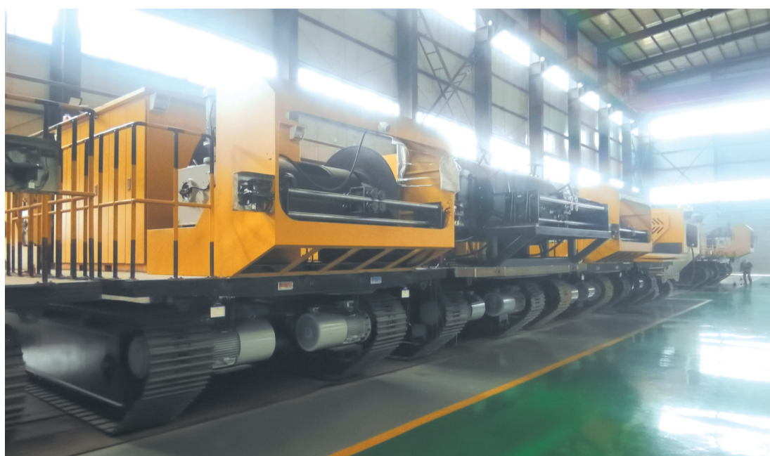
太原科技大学团队帮助企业研发的自移式电铲电缆尾线收放车。
