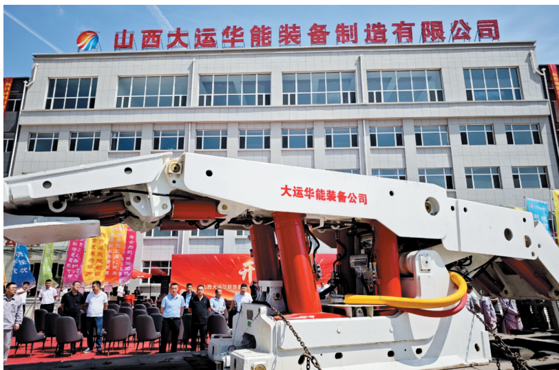
首套大型综采设备系统性改造液压支架交付现场。
