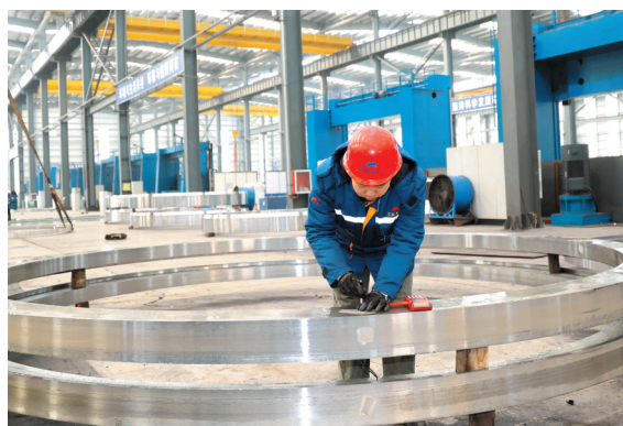
在山西宝航重工有限公司生产车间,工人正在对锻造产品进行硬度检测。 本报记者 张存良摄
